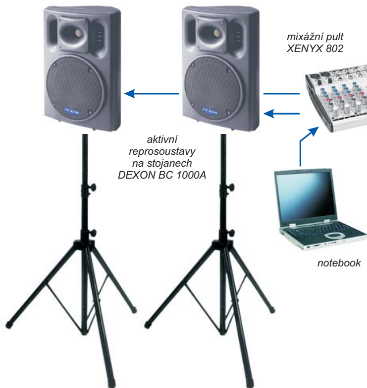
Obr. 1. Konferenční sestava založená na aktivních reprosoustavách
